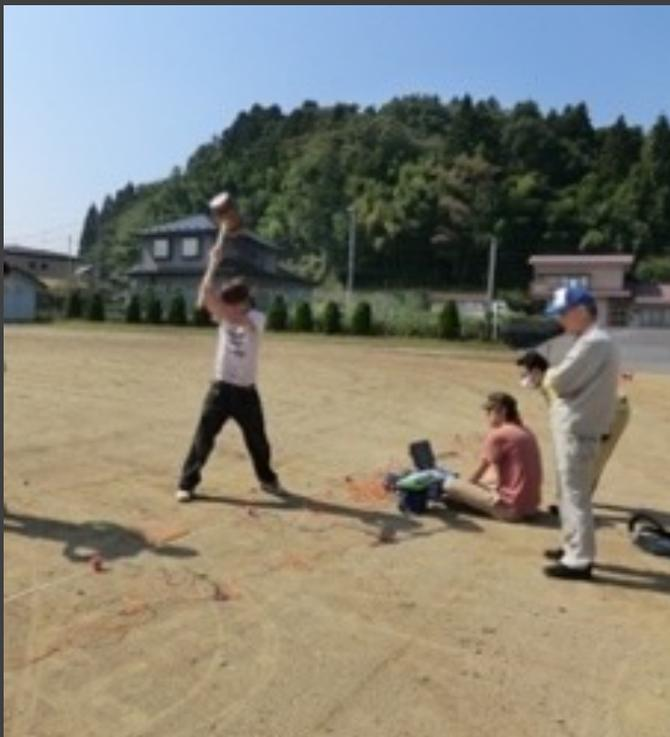
写真 東日本大震災で全壊した住宅の宅地における表面波探査（岩手県奥州市）。
