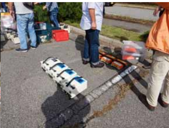
写真 岩手大学の持ち込み機器は白山工業の微動計 JU310。
