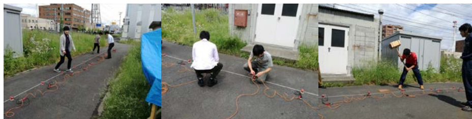
写真 表面波探査の準備と掛矢による起震。
