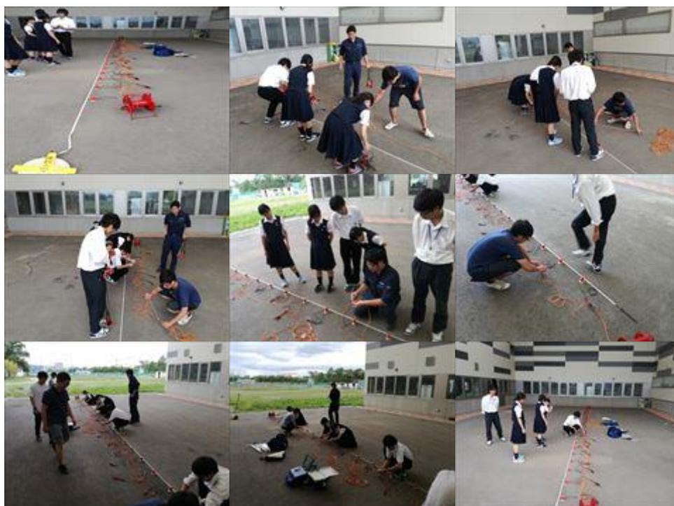
写真 表面波探査実験の様子。一直線上に地震計を並べて、かけやで地面を強打して振動を発生させ振動の伝わる様子を解析する。
