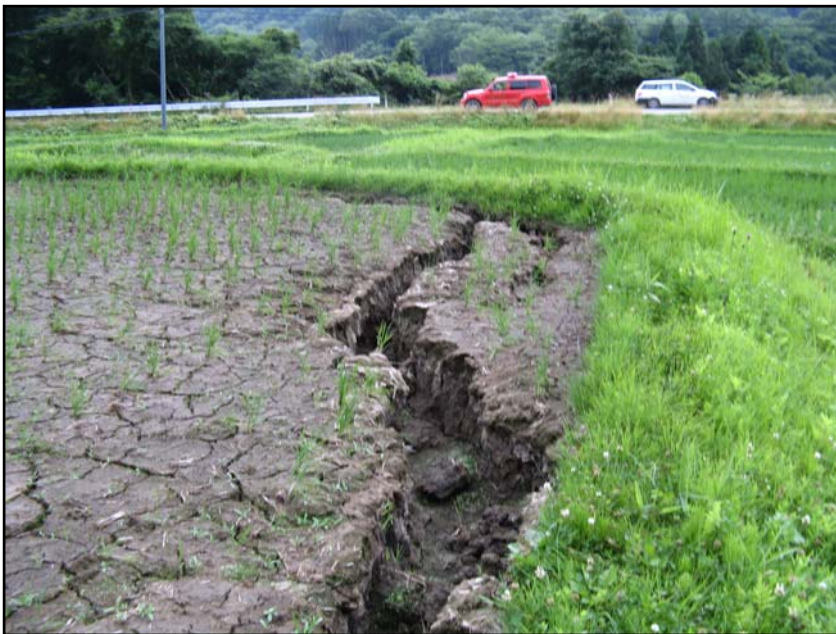
図 5. 国道 342 号線に現れた逆断層（図 4）は、赤色の消防車両と電柱の間にあります。この断層の北東延長上の田には、写真のような開口したき裂（開口幅は最大 60cm に達します）が断続して 100m ほど続き、山際の畑（写真撮影者の背後）でそれ以上の追跡ができなくなります。この開口したき裂は、逆断層の隆起部に生じたものと考えられます。2008 年 7 月 9 日撮影。
