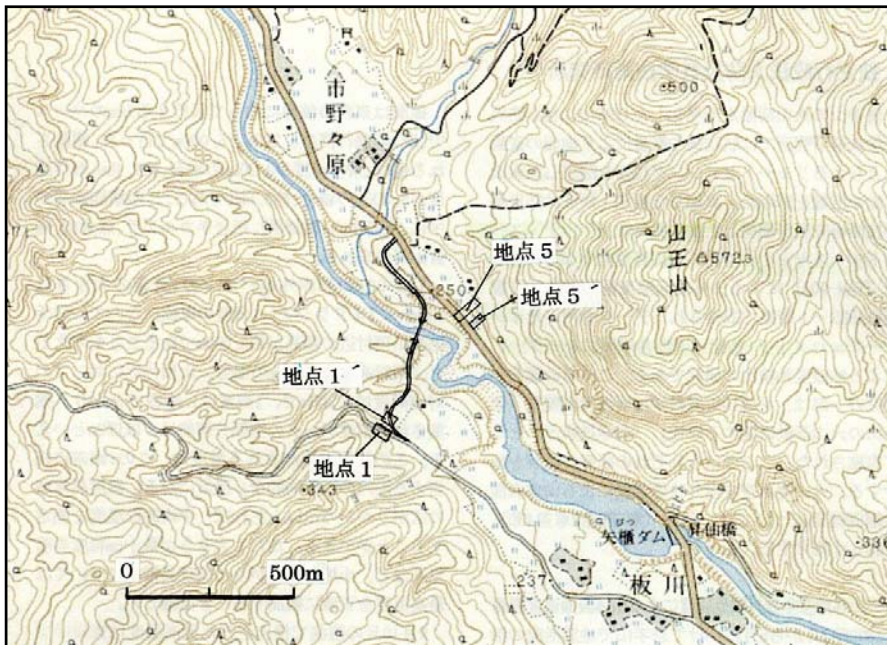
図 1. 「板川林道地震断層列」（仮称）の観察地点図です。地点 1 は板川林道に出現した隆起（背斜）の場所（第 1 報）、地点 1' はその北東約 20m の付替え道路の法面です。地点 5 と 5' は背斜の走向延長付近で確認された逆断層の出現地点です。国道 342 号線は山王山南西斜面の土砂崩れによって通行止めが続き、地点 5 と 5' は入城が難しい地点でした。黒で手書きした道路は国道 342 号線付替え道路です。今回の調査は一関市災害対策本部の許可と災害対策本部員の同行をえて実施することができました。国土地理院発行 2 万 5 千分の 1 地形図「本寺」を使用しています。
